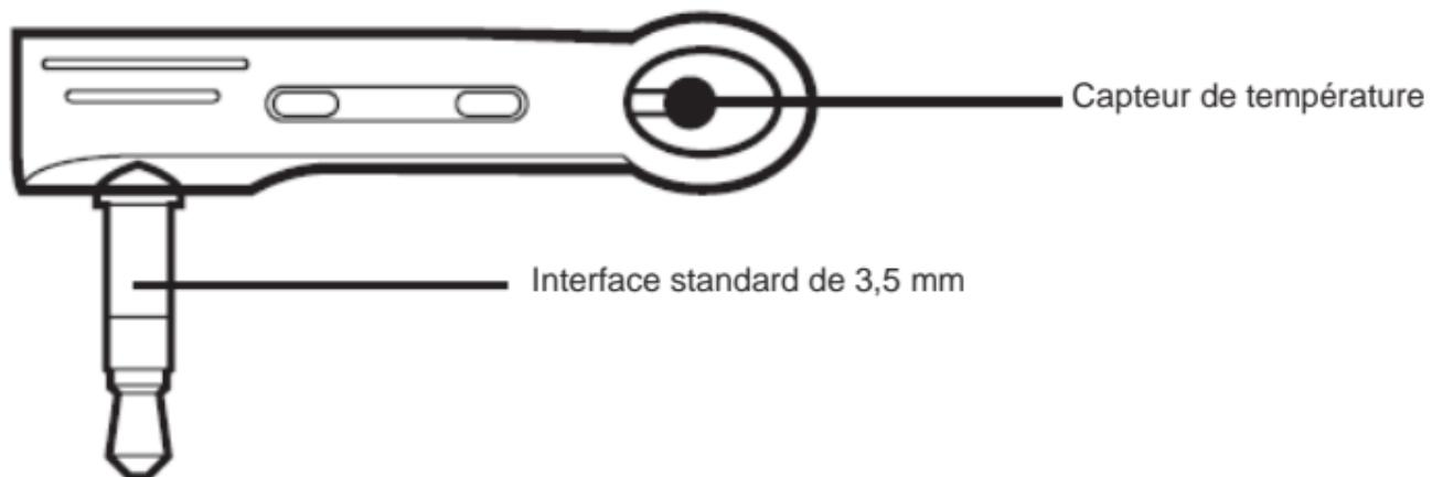
Figure 2 : Instructions du capteur de température
