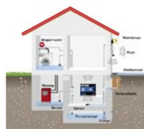
Fernüberwachung von Füllständen mit Alarmübermittlung
